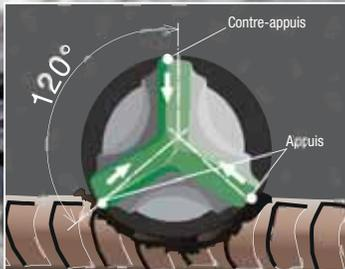
La mécanique d'appuis et de contre-appuis du Booster-Plus permet de passer tous les obstacles sans se bloquer.
